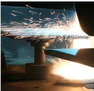
Ein neues Flammstutzverfahren für das Auftragen von Induktionsschichten kommt bei BAF zum Einsatz.
